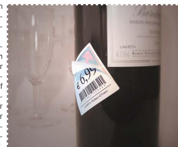
**Checkpoint Systems leistet mit den RF- (Radiofrequenz) Sicherungsetiketten auch in Sachen Labels einen wichtigen Beitrag zur Diebstahlsvermeidung. Sie sind als Sicherungsetikett nicht zu erkennen und lassen sich an der Kassa oder mittels Distanzdeaktivierer auf einfache Weise entschärfen.**
