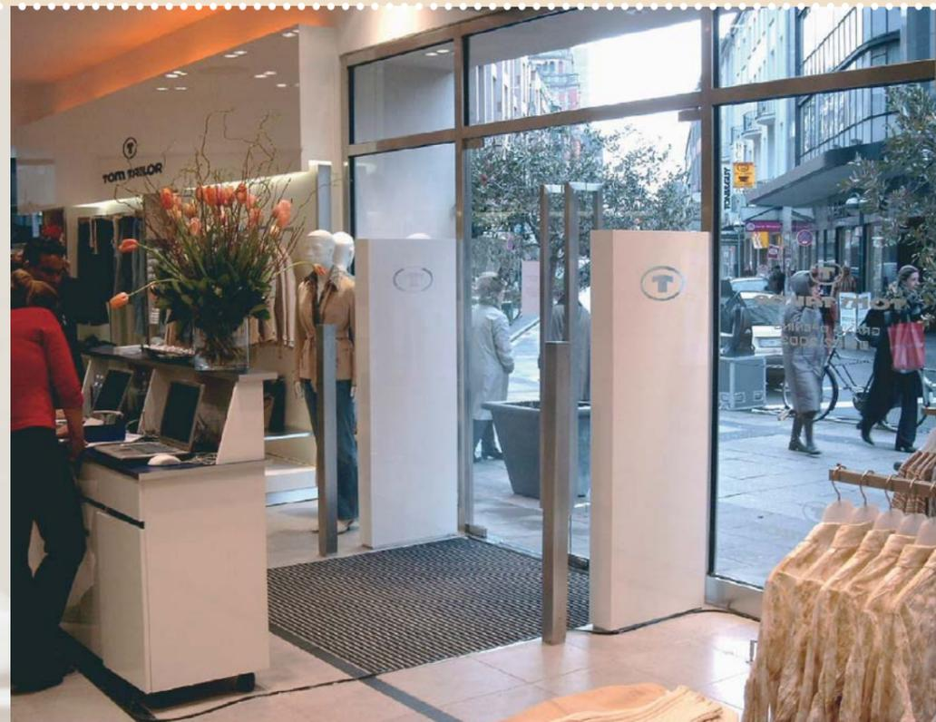
Sicherheitsschranken, wie hier im Bild die neueste Generation von Checkpoint Systems bei Tom Tailor (Dual-Frequency-Antennen, die sowohl auf 8,2 Megahertz für die Warensicherung als auch auf 13,56 Megahertz für Radiofrequenz-Identifikation RFID ausgelegt sind), sind ein wichtiger technischer Beitrag zur Diebstahlvermeidung.
